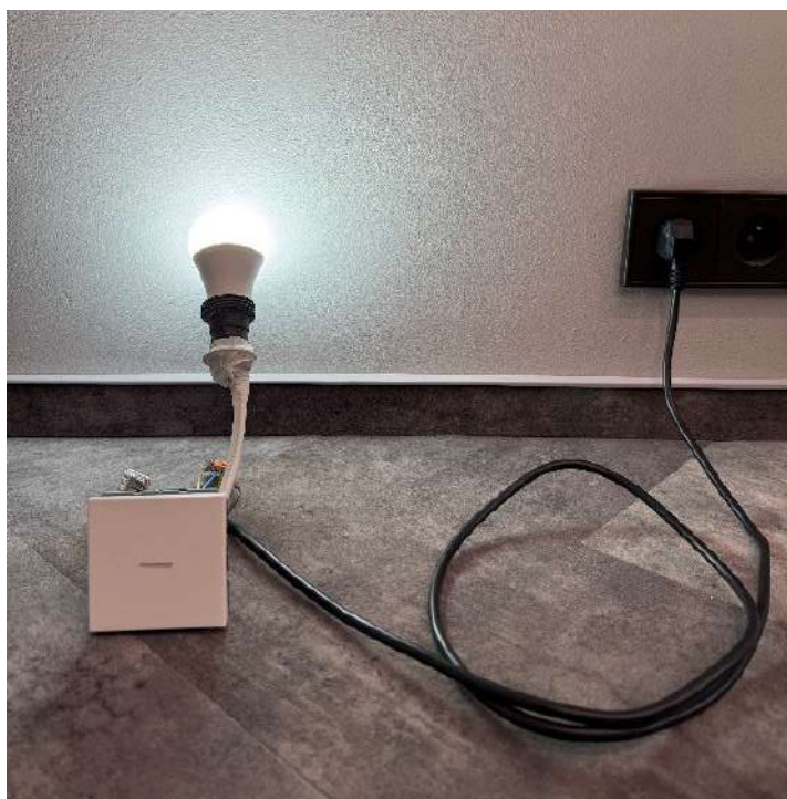
Test przycisku LS10911STRFWW razem z mechanizmem przekaźnika 1701SE, źródło: materiały QuickTec
